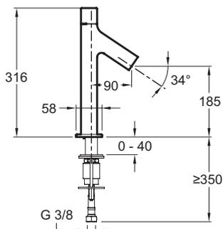
Спецификация продукта : Высокий смеситель для раковины. E10379RU. Коллекция : TALAN. ВЕС : 2.9 кг. МАТЕРИАЛ : N/A. ТИП УСТАНОВКИ : 1 отверстие. TYPE : Двурычажный. DÉBIT (L/MN SOUS 3 BARS) : 8 л/мин. HAUTEUR TOTALE DU ROBINET (MM) : 185 мм. SAILLIE DU BEC (MM) : 90 мм. RACCORDS : С гибкой подводкой. MÉCANISME : Последовательный керамический картридж. VIDAGE : Без донного клапана. TYPE D'INSTALLATION : 1 отверстие. GARANTIE FINITION : 10 лет.
