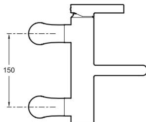
Спецификация продукта : Смеситель для ванны/душа, устанавливаемый на деку. E12769-4. Коллекция : STILLNESS. ВЕС : 4.1 кг. МАТЕРИАЛ : N/A. DÉBIT (L/MN SOUS 3 BARS) : 23 л/мин. MÉCANISME : Последовательный керамический картридж. GARANTIE FINITION : 10 лет. Скрытый переключатель ванна/душ. Обратный клапан в комплекте.
